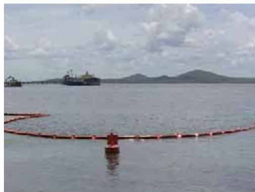
Confinement/ récupération des hydrocarbures du *Global Peace* par barrage flottant et barges récupératrices de type *Slickbar* (Source : AMSA/MSQ et ABC)
