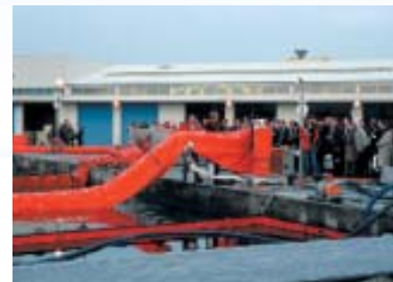
Déploiement du barrage autogonflable (Expandi)
