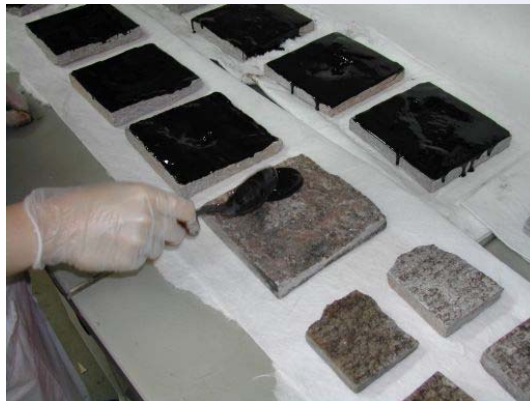
Application en excès du fioul lourd.
