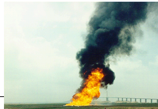
Feu de nappe de GNL sur l'eau (Essais Gaz de France)
