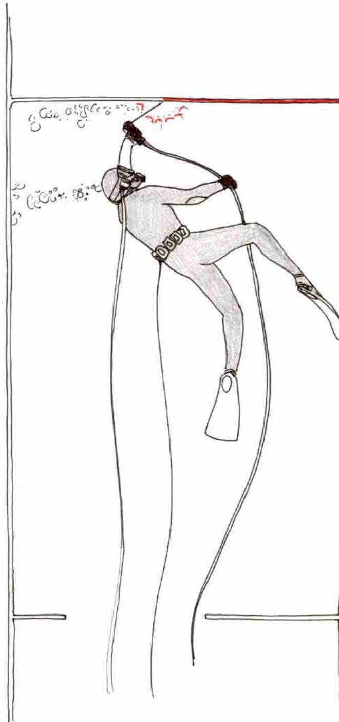
Découpage au moyen d'électrodes sous-marines
