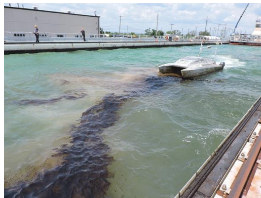
Tests en 2019, à l' Ohmsett , de l'efficacité de la dispersion mécanique de surface par le prototype d'USV Vorax (source : Blue Impact )
