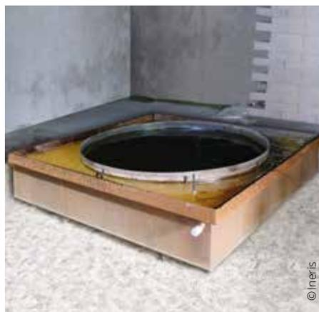
▲ Dispositif de brûlage à échelle pilote
