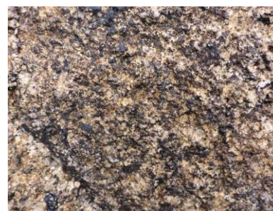
janvier 2019 : Détail des traces résiduelles de fioul après une 1 ère passe en NHP (secteur Casabianca/Roche Escudelier, Ramatuelle) (Source : Cedre)
