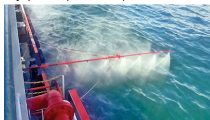
Epandage de dispersants par rampes à partir d'un remorqueur (Source : Ceylon Petroleum Corporation)
