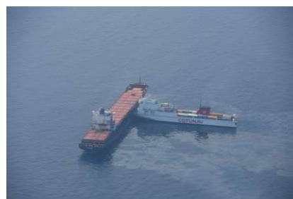
Le roulier Ulysse encastré dans l'avant tribord du porte-conteneurs CSL Virginia, et fuite de fioul de propulsion de ce dernier (source : MN)
