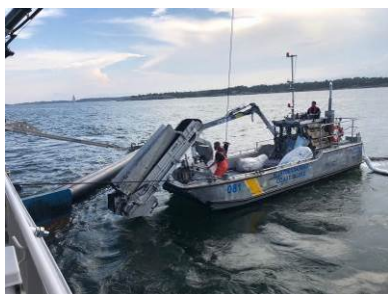
Collecte du fioul flottant issu du Makassar Highway en frange littorale : mise à l'eau d'un dispositif écremeur oléophile à brosses linéaires (Lamor Bow Collector) à partir d'un chaland récupérateur ( gche ) ; Transfert du fioul visqueux stocké dans les capacités du chaland ( dte ) (source : Kustbevakningen)
