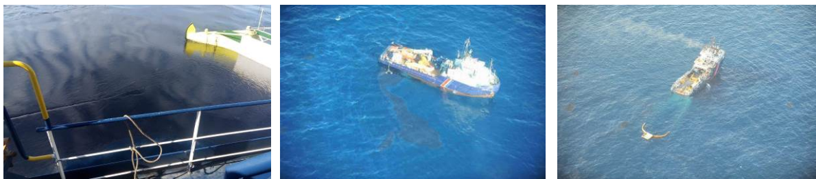
Diverses modalités de récupération (exemples, de gauche à droite) : Confinement d'une nappe flottante via les bras rigides du Brezzamare (Source : AESM) ; Récupération de nappes fragmentées de fioul par le BSAD Ailette au moyen d'un écremeur à mécanique à déversoir (Sea Skater) (Source : DF) ; Chalutage de fioul épars par filets de surface (Thomsea) à partir du BSAD Jason (source : DF)
