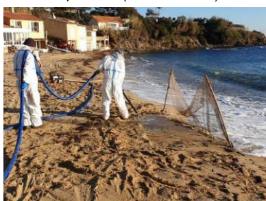
Brassage (jets d'eau basse pression) de sables en zone de déferlement, pour collecte de boulettes enfouies (Source : LFD)
