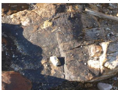
Traces résiduelles après grattage des épaisseurs de fioul, en attente de traitement par NHP (source : Cedre)
