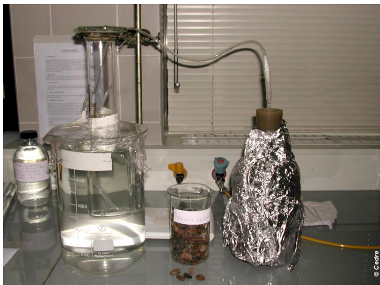
Dispositif expérimental permettant de récupérer le dégagement gazeux ©CEDRE
