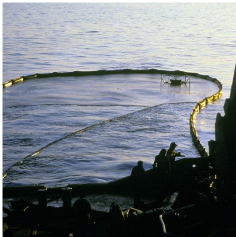
Le TRANSREC récupérant du pétrole en fond de barrage ©CEDRE
