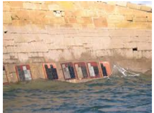
Installation des plaques sur la zone expérimentale ©CEDRE
