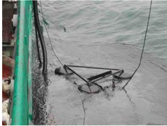
Pompage direct dans la nappe par le Foilex à bord de l'Ailette ©CEDRE
