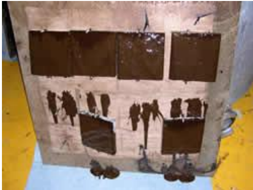
Pollution de plaques de granite pour une étude de persistance sur substrat rocheux ©CEDRE
