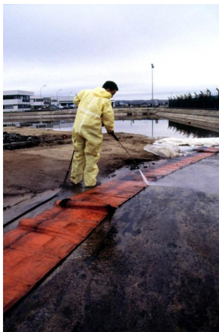
Nettoyage par l'entreprise de son matériel de lutte antipollution sur le plateau technique du CEDRE ©CEDRE
