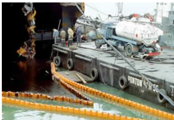
Confinement par barrages et récupération par tonne à vide ©CEDRE
