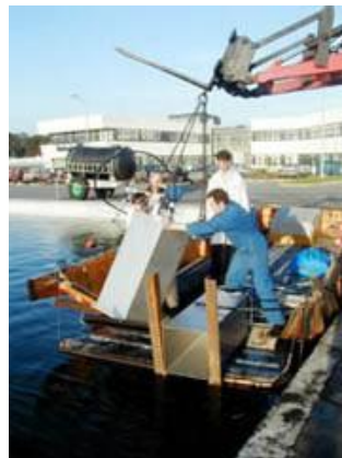
Immersion de cuves en inox dans un bassin extérieur d'eau de mer ©CEDRE
