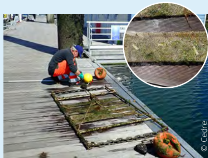
▲ Dispositif immergé pour étudier la dégradation des mégots, installé à la Marina du Château, en collaboration avec les ports de plaisance de Brest
