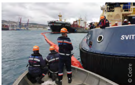
∧ Déploiement d'un barrage antipollution
