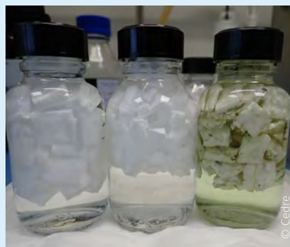
^ Étude de relargage de contaminants par des PSE neufs et vieillis sur la plage artificielle du Cedre
