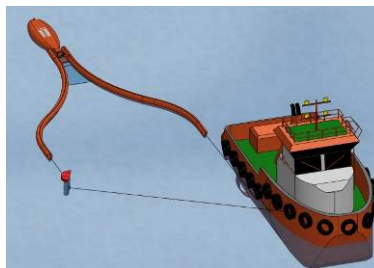
Le NO-T-600-S (gauche) et schéma de remorquage avec paravane (droite) (Source : Norlense)
