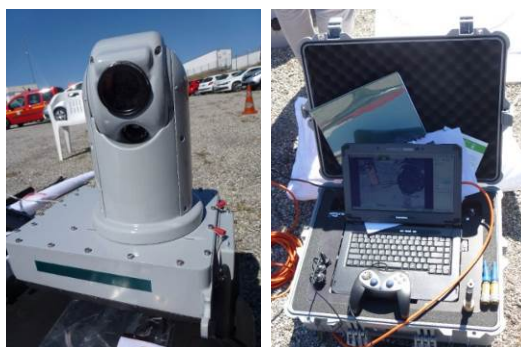
Vues de la tourelle avec caméras IR et vidéo (gauche) et du pupitre de commande compact (droite) (Source : Cedre)
