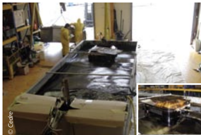
Test de récupérateur Vikoma « Komara Duplex » sur le plateau technique du Cedre
