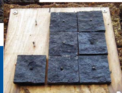
Expérimentation sur l'autonettoyage des substrats à l'île des morts (rade de Brest)
