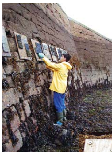
Expérimentation sur l'autonettoyage des substrats à l'île des morts (rade de Brest)
