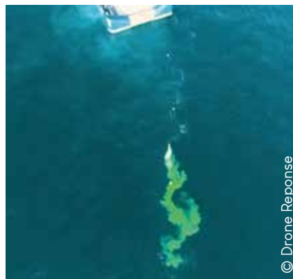
Nappe de fluorescéine photographiée lors de la phase préparatoire à l'essai IPOMAC prévu en 2021
