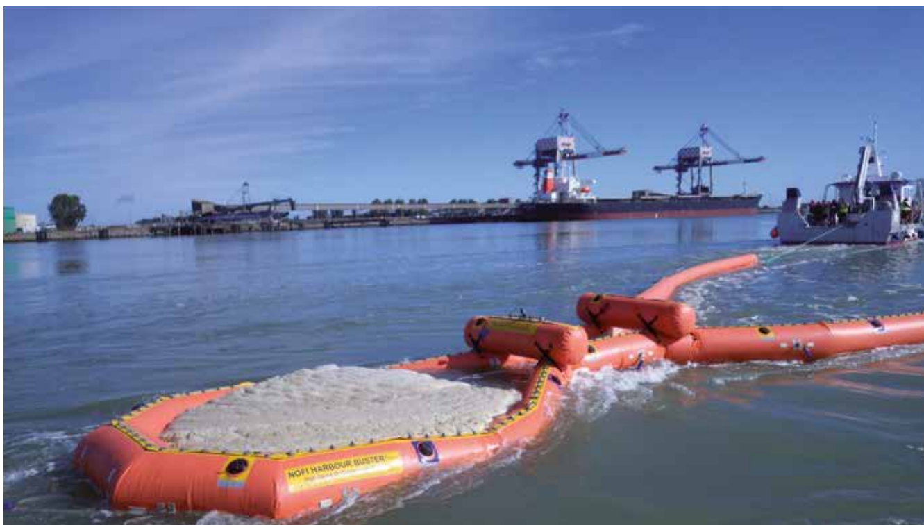
Essai NOFI Current Buster 2 sur la Loire © Cedre
