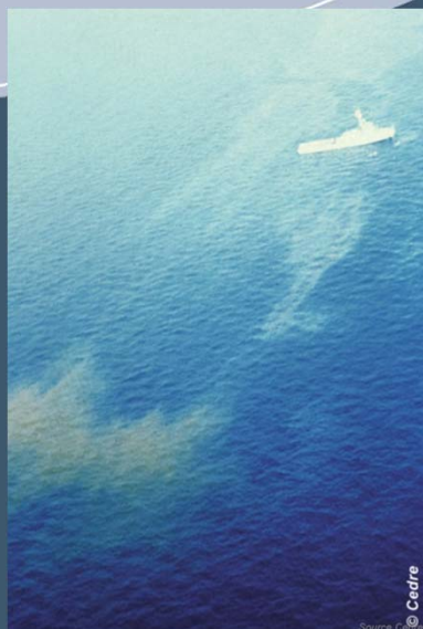
Observations de deux nappes de pétrole (traitée et non traitée au dispersant)
