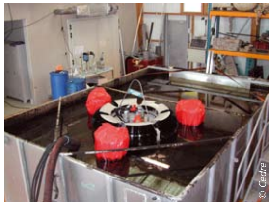
Essais sur le récupérateur DESMI Helix
