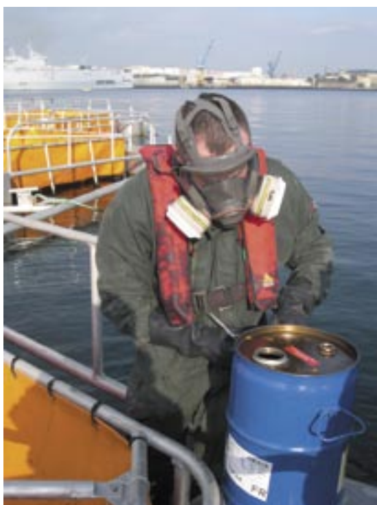
Essais en cellules flottantes : déversement de toluène
