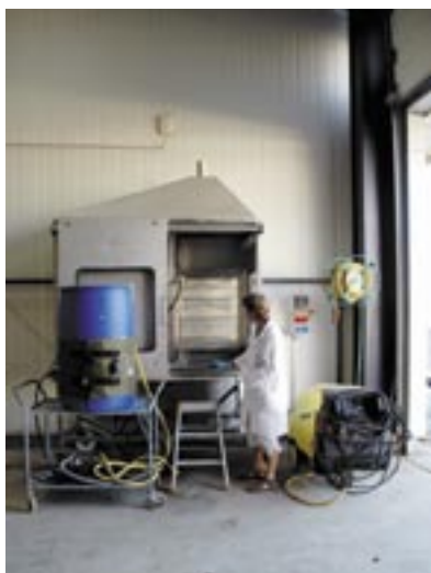
Banc d'évaluation des produits de lavage dans le hall d'essais
