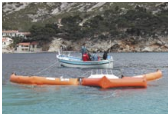
Essais de chalut ECREPOL en calanque de Sormiou (↑) et du récupérateur TAPI sur le plateau technique du Cedre (↓)
