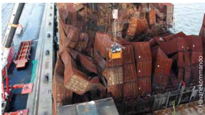
Élingage d'un conteneur endommagé
