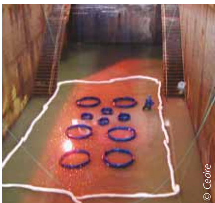
Test de sondeur acoustique en bassin. Projet RITMER EXCAPI
