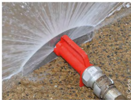
滅火系統水帶/噴嘴/扇形瞄子
