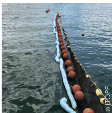
由網子和吸附劑製成的訂製攔油索，用於處理硬質棕櫚油洩漏。
