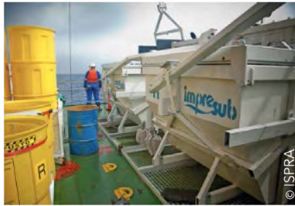
用在海底收集桶子的專門架子和打撈桶。
