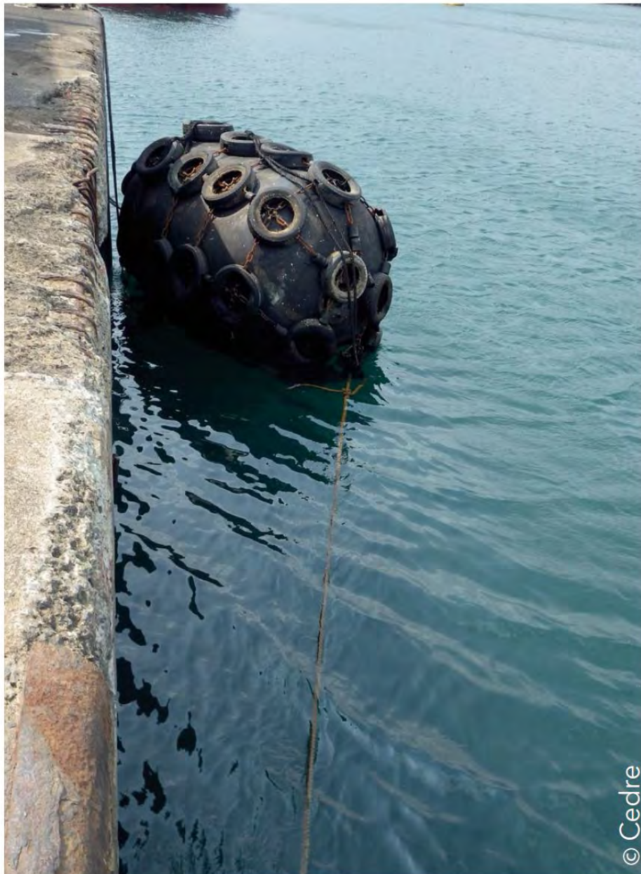
用於允許兩艘船之間接近的橫濱式充氣橡膠碰墊。
