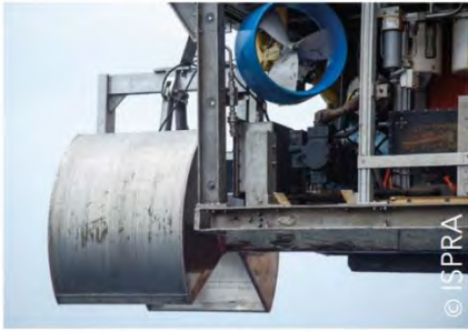
架在等級 II ROV的 抓取取樣器
