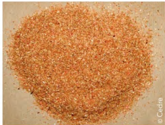
散裝吸附劑用於 ( 在侷限區域 ) 增加海面液體的厚度和黏度或干預固體污染的表面。
