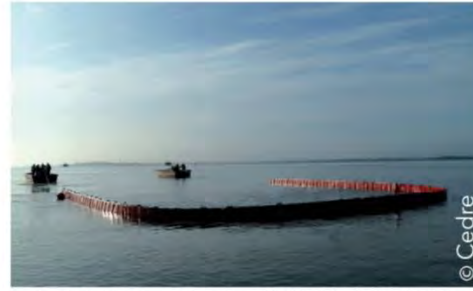
採用「U」型配置的傳統充氣欄油索進行動態圍堵。
