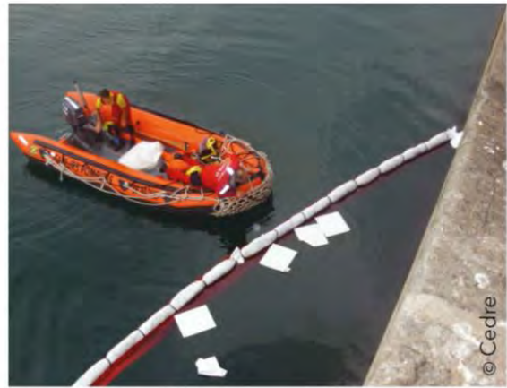
吸附片用於回收低/中黏度漂浮液體污染物。
