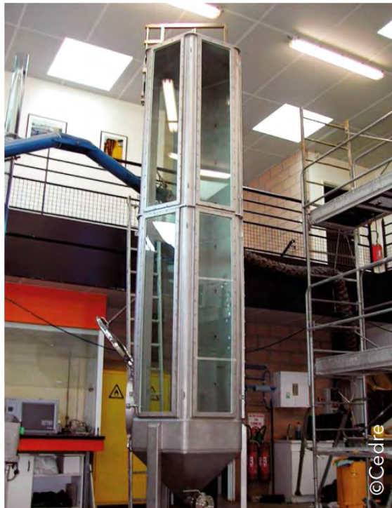
研究化學品（或油）在水柱中上升或下沉時的行為的實驗水柱。
