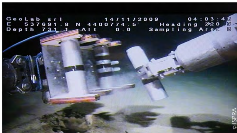
在深海底使用 ROV 進行沉積物採樣。
