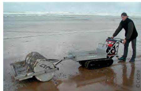
▲ Demostración de un rodillo oleófilo empujado por un tractor oruga. Girona (33)
