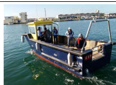
Navire Seismic Workboats pour déploiement de barrages flottants (Source : SWB)
