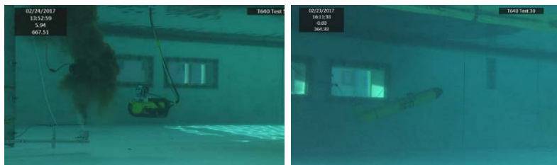
Gauche : ROV en cours de mesure de tailles de bulles de méthane et de gouttelettes de brut ; Droite : Glider en cours de mesure d'épaisseur de nappe flottante de pétrole brut (Source : ARA / VIMS)
