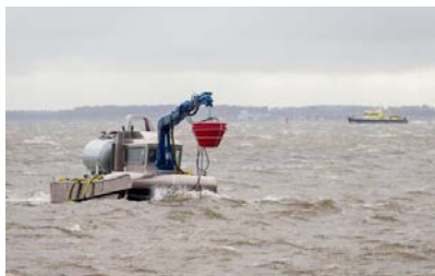
Gauche: Exercice d'intégration de bénévoles pour le nettoyage manuel en Mer de Wadden; Droite: Utilisation de la plateforme amphibie Wadcrawler avec récupérateur FORU (Source : Rijkswaterstaat)
