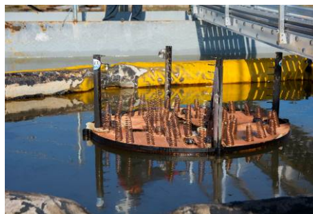
Le prototype du Flame Refluxer ® testé dans les installations du JMTF de Little Sand Island (Source : WPI)
