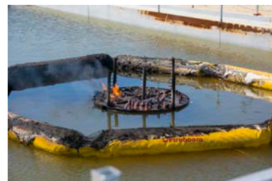
Gauche : Installation du prototype par les ingénieurs du WPI dans le bassin du JMTF (noter l'utilisation d'un barrage anti feu American Fireboom d'Elastec) ; Centre : Vue des panaches de suie (relativement peu denses, d'aspect grisâtre) générés par l'ISB avec Flame Refluxer ; Droite : vue du prototype en fin de brûlage de nappe ; (Source : WPI)
