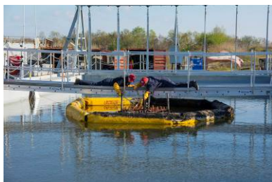
Gauche : Installation du prototype par les ingénieurs du WPI dans le bassin du JMTF (noter l'utilisation d'un barrage anti feu American Fireboom d'Elastec) ; Centre : Vue des panaches de suie (relativement peu denses, d'aspect grisâtre) générés par l'ISB avec Flame Refluxer ; Droite : vue du prototype en fin de brûlage de nappe ; (Source : WPI)
