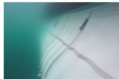
Vue de la jupe (3 m de tirant d'eau) (Source : Ocean Cleanup )
