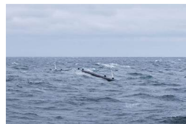
Vue du flotteur du prototype : tubes en PEHD (Source : Ocean Cleanup )
