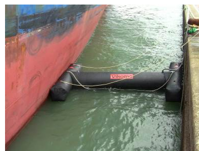
Vue du Vikoseal déployé entre un navire et un quai (Source : https://www.vikoma.com/ )
