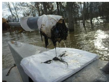
Outil « low-tech » et efficace pour la détection de pétrole coulé (Source : NOAA)
