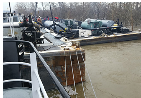
23/01/16 : Operations d'allègement de la barge citerne MM-46 (par pompage/tranfert vers barge à couple) (source : USCG)
