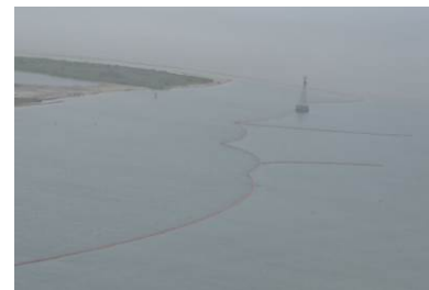
J+6 : Pose de barrages flottants en mode de protection littorale (Matagorda Island) (Source : USCG/Unified Response)
