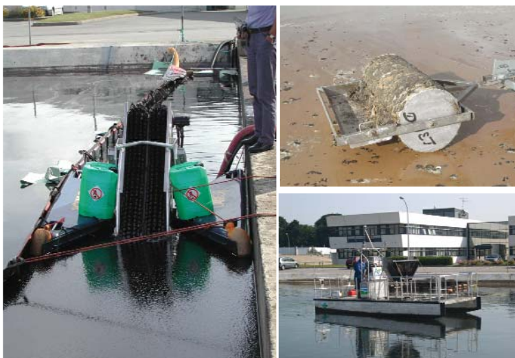
En haut, essais de rouleau oléophiles (Djet) sur le terrain lors de la pollution du Prestige, A gauche test de récupérateur à brosses oléophiles (Lamor) En bas, essais de barge de dépollution portuaire "Cataglop" (Armor Technique)
