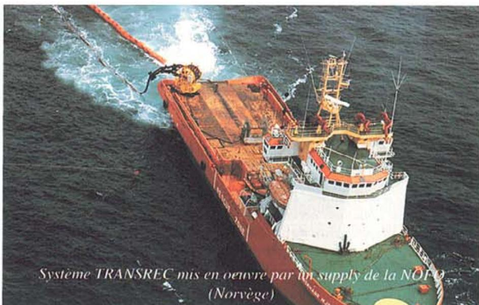
*Système TRANSREC mis en œuvre par un supply de la NOF O (Norvège)*
