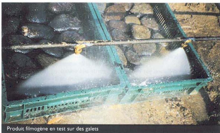
Produit filmogène en test sur des galets
