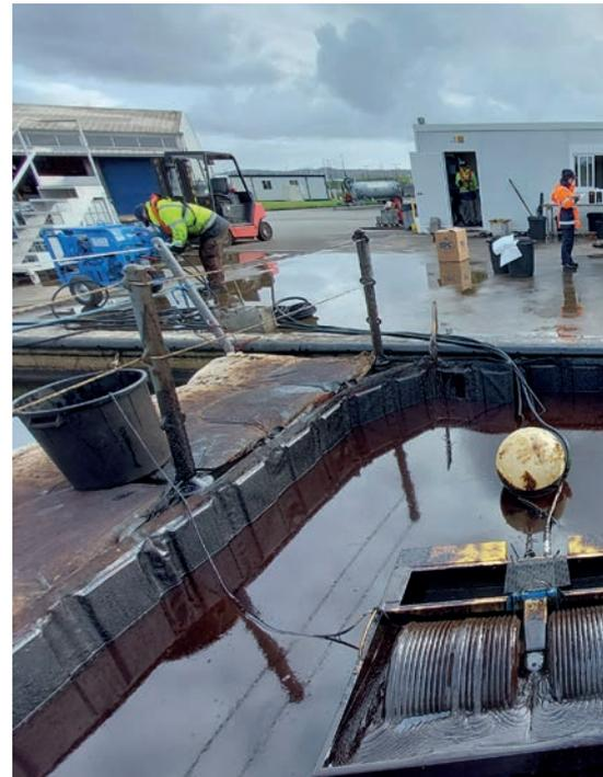
▲ Test d'un récupérateur oléophile à tambour cannelé dans le bassin d'essais du Cedre
