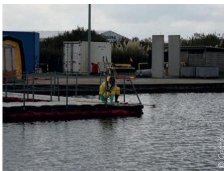
^ Déversement d'un produit chimique dans le bassin du Cedre puis détection par la Sécurité Civile belge à l'aide d'un détecteur basé sur la spectrométrie infra-rouge
