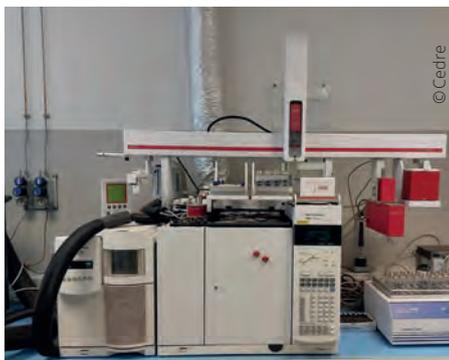
^ Chromatographie en phase gazeuse couplée à la spectrométrie de masse qui permet d'identifier les hydrocarbures
