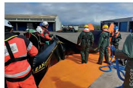
^ Déploiement d'un barrage gonflable sur le bassin du Cedre
