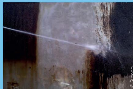
^ Essai de nettoyage d'un mur préalablement traité au Balarep
