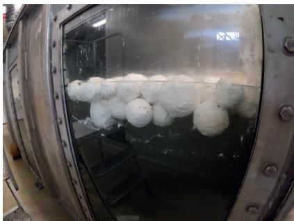
Boules de graisse animale obtenues après vieillissement d'une nappe de graisse animale au Polludrome®
