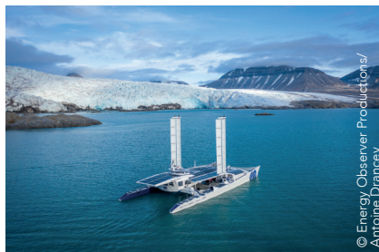
Energy Observer - Premier navire autonome en énergie grâce à son unité de transformation de l'eau de mer en hydrogène.
